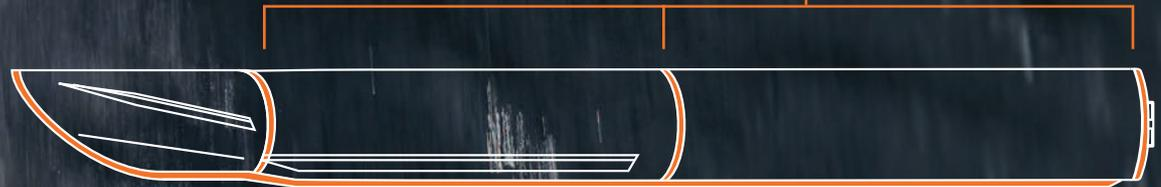
*Nous doublons la structure arrière pour augmenter la rigidité près du puits à moteur.*
